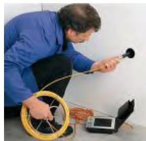
[Mini-Kamera sustav](#) spremljen u aluminijski kovčeg
