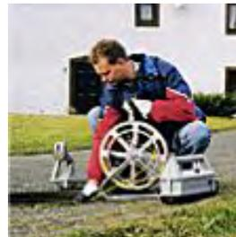
Za lociranje cijevi malog promjera kakve se primjenjuju u kućnim instalacijama koristi se model "Max" .
