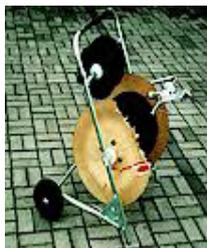
Osobito pogodno za razmatanje kabela kod oštećenja jednokratnih bubnjeva
