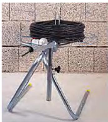
Katimex naprave za razmatanje kabela s kružnim vijencem nezaobilazne su na gradilištima, i trgovinama kabela. Laganookretni poslužni tanjur postavljen na kugličnim ležajima, kao i masivni stalak su galvanizirani. Integrirana kočnica kontrolira centrifugalnu silu omogućujući uredno odmatanje i sprječavajući neželjeno zaplitanje.
