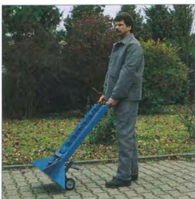
Hidraulički podizači bubnjeva također imaju podesiva ležišta osovine. Kod manje izvedbe ležište se može postaviti na 7 položaja, a kod veće na čak 13 položaja. Naravno u ovom slučaju se podizanje bubnja izvodi pomoću hidraulike. Zahvaljujući velikom izboru mjesta za postavljanje ležišta osovine osigurano je minimalno dizanje pomoću hidraulike a time i brzo obavljanje podizanja.
