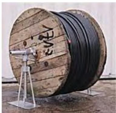
Svaki podizač kablskog bubnja teži samo 13 kilograma. Unatoč toj laganoj izvedbi moguće je podizati bubnjeve do 2 tone težine. Nosači se jednostavno postavljaju pod osovinu pomoću mehanizma s račnom i kočnicom. Bubanji se tada jednostavno podiže na radnu visinu pomoću poluge.
