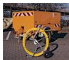
Pipe Eel je moguće naručiti sa poteznim užetom duljine do 300 m. Na toj udaljenosti moguće je povlačenje laganih telekomunikacijskih i energetskih kabela bez upotrebe motornih naprava za povlačenje kabela.
