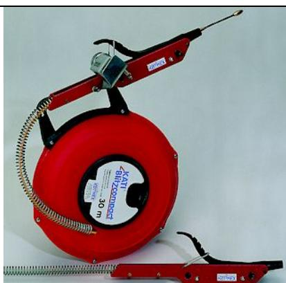
Kod uvlačenja kabela u dugačke i prazne instalacijske cijevi npr. u poslovnim zgradama, bolnicama i sl. pokazuju se prednosti motornog pogona. Zbog moguće velike brzine uvlačenja postiže se ušteda vremena i do 60% u odnosu na ručno uvlačenje.
